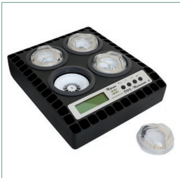
Четырехканальный ДНК-амплификатор «Терцик» предназначен для проведения амплификации в пробирках по 0,5 мл. Прибор выполнен в виде единого модуля, объединяющего четыре независимо управляемых термоблока.
